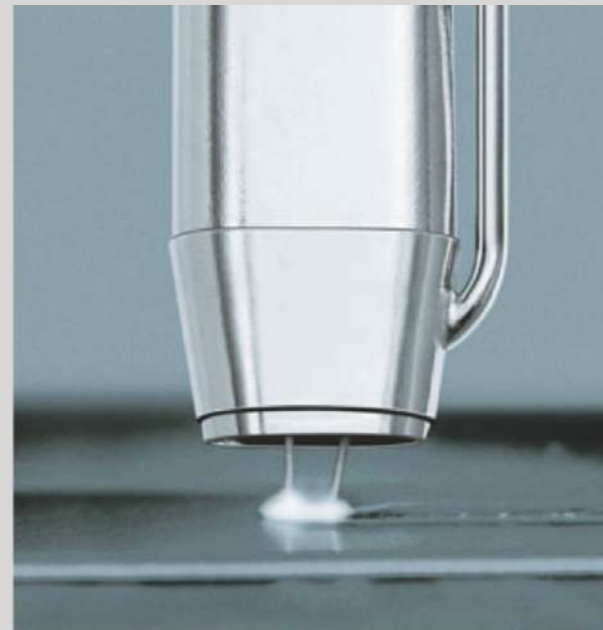
处在同一个焊枪喷嘴中两根独立的焊丝，形成同一个熔池。
