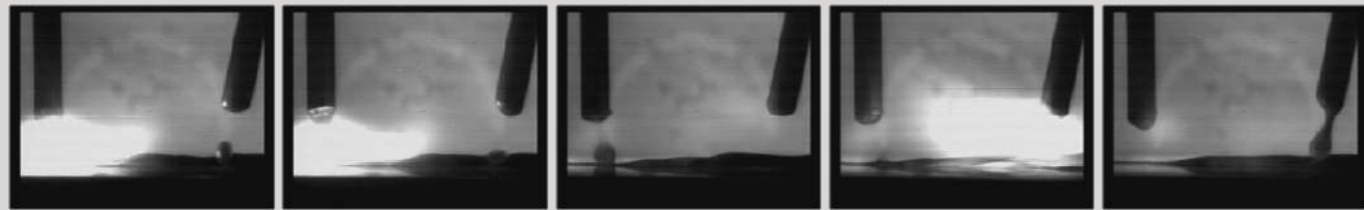
Time Twin Digital数字化双丝焊系统脉冲电弧，金属熔滴过渡相位差180°。
