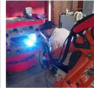
耐蚀层的修复（镍合金）
