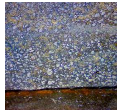
碳化钨焊缝金相图
